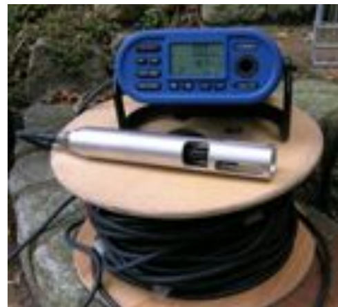
Abbildung E5: TS-Sonde mit Messgerät, Kabeltrommel und Messkopf
