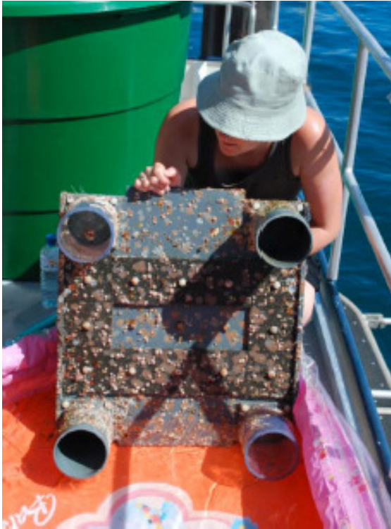
Abbildung 8: Nach einjähriger Exposition in der Tiefe waren die Paneele oft dicht besiedelt
